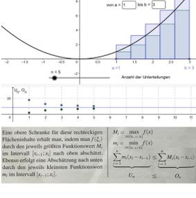
Eine obere Schranke für diese rechteckigen Flächeninhalte erhält man, indem man  $f(x)$  durch den jeweils größten Funktionswert  $M_i$  im Intervall  $[x_{i-1}, x_i]$  nach oben abschätzt. Ebenso erfolgt eine Abschätzung nach unten durch den jeweils kleinsten Funktionswert  $m_i$  im Intervall  $[x_{i-1}, x_i]$ .
