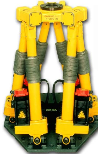
FANUC F-200i (Hexapod-Bauweise)
